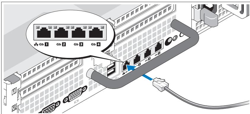
Conekte um cabo Ethernet a um dos conectores Ethernet na parte traseira do sistema.
