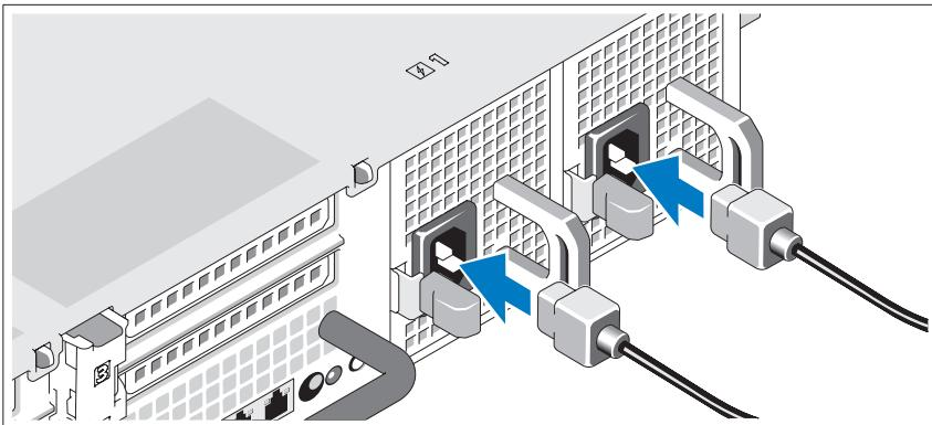
Conecte os cabos de alimentação ao sistema.
