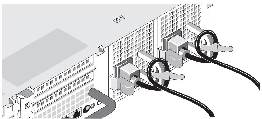
Dobre o(s) cabo(s) de alimentação do sistema formando um laço, conforme mostrado na figura, e prenda-o(s) com a tira fornecida.
