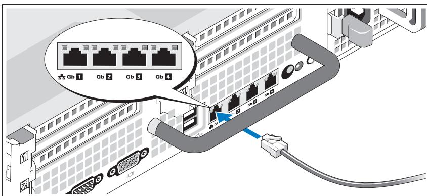
Branchez un câble Ethernet sur l'un des connecteurs Ethernet à l'arrière du système.
