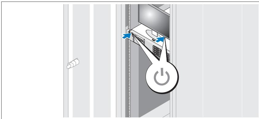
Pulse el botón de encendido del sistema y del monitor. El indicador de alimentación debería encenderse.
