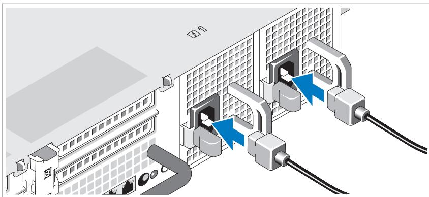
Conecte los cables de alimentación al sistema.
